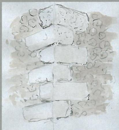
Chaîne d'angle en harpe de calcaire lacustre,
